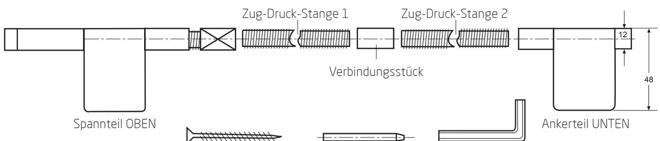
Der Spannteil des Beschlages dient als Lehre zur Markierung der Position für die Bohrung  $\varnothing 4$  mm, in der – siehe nächste Abbildung – mittels Spax-Schraube 6x120 der Beschlag im eingebauten Zustand fixiert wird.
